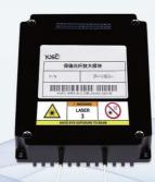
保偏 EDFA 模块使用 980nm 泵浦激光提供能量,采用保偏无源器件,具有较高的输出消光比。 产品可在 ACC/APC/AGC 模式下进行工作,采用高性能器件及精确控温技术,使产品在较宽的 温度范围内具有良好的工作特性,已广泛应用于光纤传感领域。
